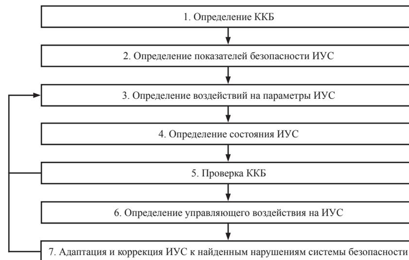
Рисунок 3. Блок-схема адаптивного управления безопасностью ИУС
